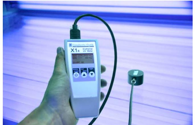
*X1<sub>4</sub> in der Anwendung zur Vermessung der UV-Bestrahlung von UV-Bestrahlungsgeräten*
