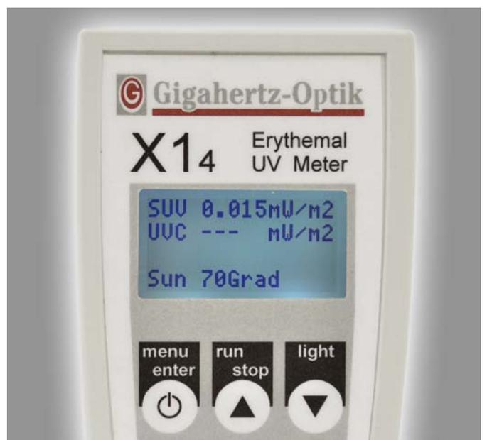
*Direkte Anzeige der UV Erythem wirksamen und UVC Bestrahlungsstärke, im Bild mit ausgewähltem Korrekturfaktor für Sonnenstrahlung mit 70° Zenitwinkel*
