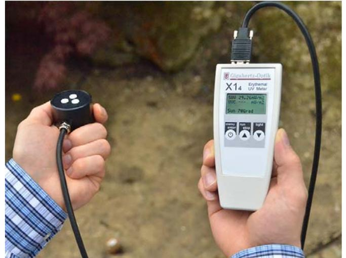
*X1<sub>4</sub> in der Anwendung zur Vermessung der UV-Bestrahlung durch Sonnenstrahlung.*
